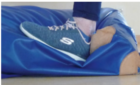
Abb. 38: Fersenprüfung – Die Weichbodenmatte schlägt bis auf den Boden durch. Die Matte hat nicht die Fallschutzeigenschaften einer echten Weichbodenmatte.
