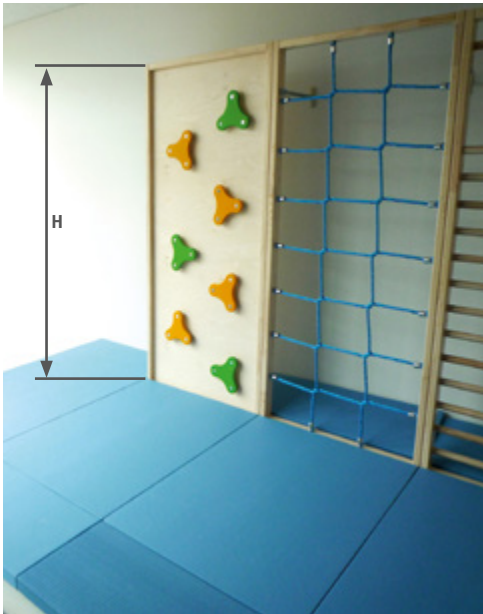
Abb. 37: Sprossen-/Kletterwand – Fallhöhen ( H = oberste Sprosse, oberer Querholm)
